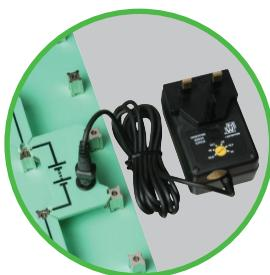
La fuente de alimentación regulable se enchufa en varios tipos de soportes Locktronics para completar el diagrama del circuito.
