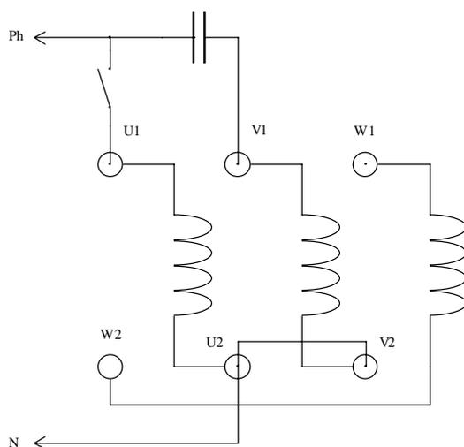
Deux enroulements sont déphasés à l'aide d'un condensateur.
