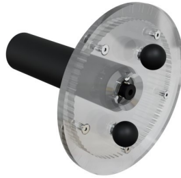
Cylindre taraudé fixé à un rapporteur circulaire (feuille de travail 2)
