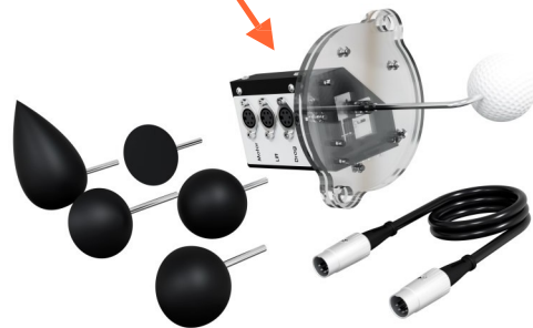
Module à deux forces • connecté au profil aérodynamique (Fiche de travail 4) • connectées pour tester les formes (fiche de travail 5)
