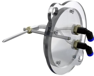
Support d'expérience pour le tube de Pitot statique (fiche de travail 1)
